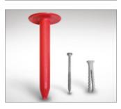
В основание из бетона класса В15-В25 или армированной цементно-песчаной стяжки толщиной не менее 50 мм из раствора не ниже М150 для крепления Техноэласта СОЛО по теплоизоляционным плитам применяйте кровельный остроконечный винт ТехноНИКОЛЬ Ø 4,8 мм в сочетании с полиамидной анкерной гильзой длиной 45 или 60 мм.
