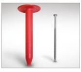
В основание из стального профилированного настила для крепления Техноэласта СОЛО по теплоизоляционным плитам применяйте телескопический крепеж и сверлоконечные саморезы ТехноНИКОЛЬ
