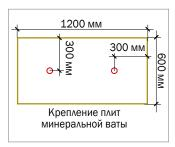
Необходимо устанавливать не менее двух крепежных элементов на плиту утеплителя размером 1200х600 мм
