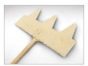
Для очистки снега по основанию из стального профилированного настила можно использовать специальную лопату, повторяющую форму настила.
