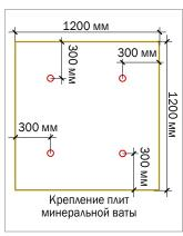
Необходимо устанавливать не менее 4 крепежных элементов для плит длиной и шириной более одного метра.
